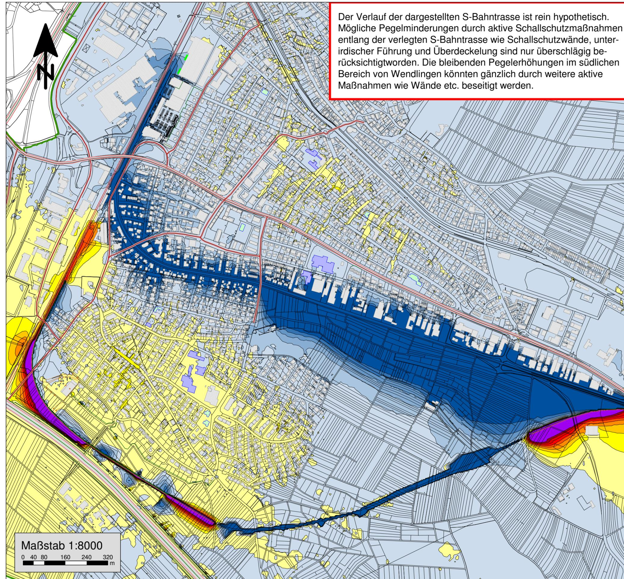
Der Verlauf der dargestellten S-Bahntrasse ist rein hypothetisch. Mögliche Pegelminderungen durch aktive Schallschutzmaßnahmen entlang der verlegten S-Bahntrasse wie Schallschutzwände, unterirdischer Führung und Überdeckung sind nur überschlägig berücksichtigt worden. Die bleibenden Pegelerhöhungen im südlichen Bereich von Wendlingen könnten gänzlich durch weitere aktive Maßnahmen wie Wände etc. beseitigt werden.
