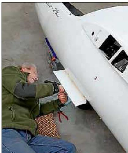
Überprüfung des Einziehfahrwerks
